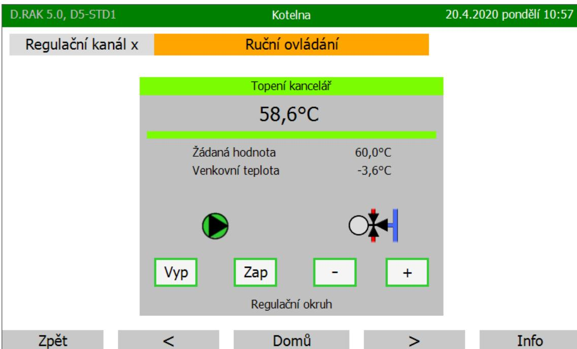
Tlačítka „Vyp“, „Zap“ zde slouží k ovládání čerpadla, tlačítka „-“, „+“ slouží k ovládání servopohonu – držením tlačítka „-“ servopohon zavírá, držením tlačítka „+“ servopohon otevírá.
